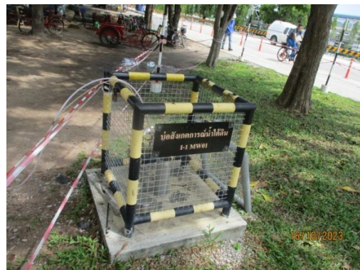
บ่อสังเกตการณ์น้ำใต้ดินท้ายน้ำ บริเวณด้านทิศใต้ของโรงงาน GC2 (MW01)
